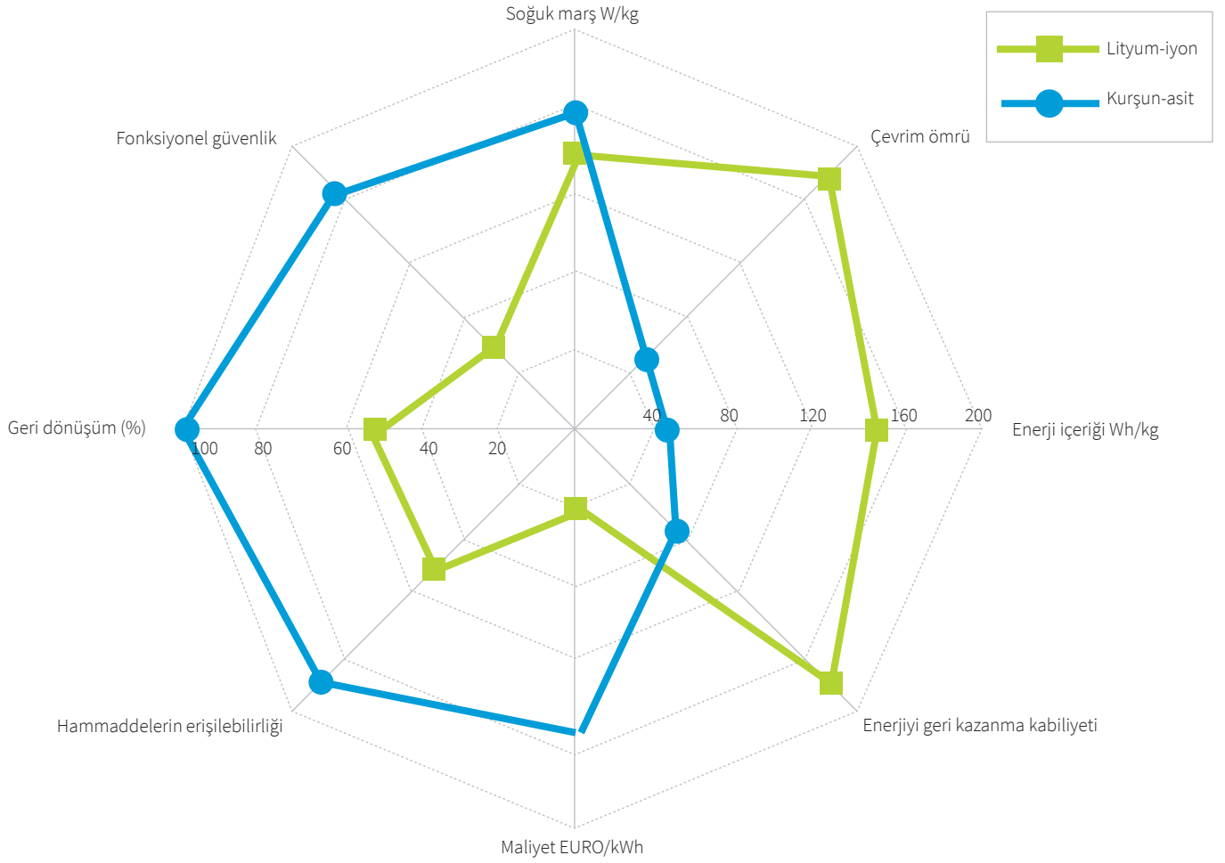
Şekil 9: Otomobil marş aküsü olarak kurşun-asit ve lityum-iyon bataryaların karşılaştırılması
